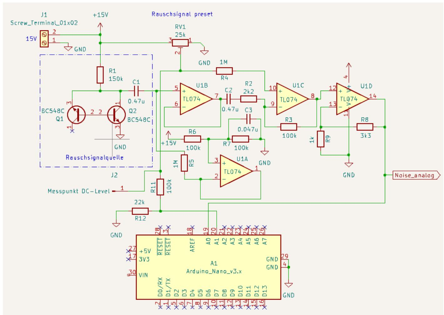
Unser Rauschsignal ist am Ausgang der Schaltung bei „Noise\_analog“ verfügbar. Sie können es in einen Verstärker einspeisen und am Ausgang des Verstärkers mit einem Spektrumanalyzer überprüfen, ob der Signalverlauf über die Bandbreite des Verstärkers Amplitudenverluste erlitten hat.
