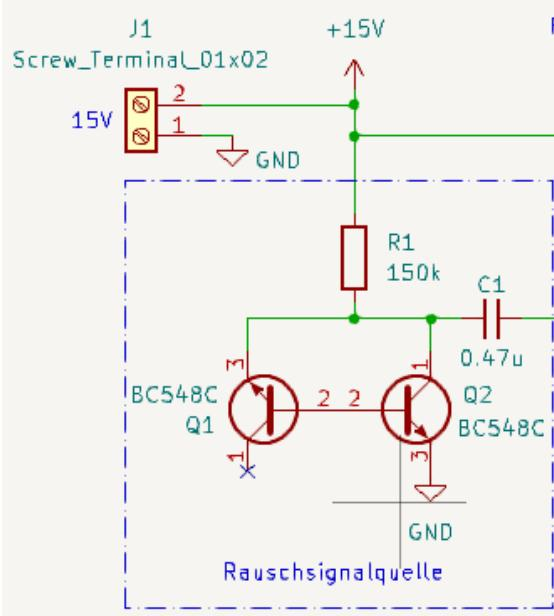
Die Rauschquelle besteht in unserem Fall aus zwei npn-Kleinsignaltransistoren BC548C. Die Rauschquelle ist Q1, während Q2 als Stromquelle dient.
